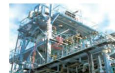
回収フロンガス破壊設備
