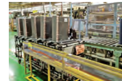
従業員自らの提案で推力を利用した「からくり」。省エネルギーを実現しながら、部品を生産ラインへ供給しています。
