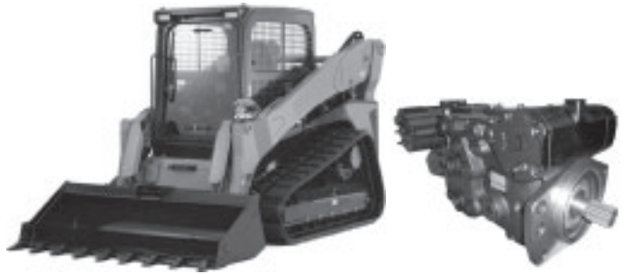
建設機械（左）と油圧トランスミッション（右）
