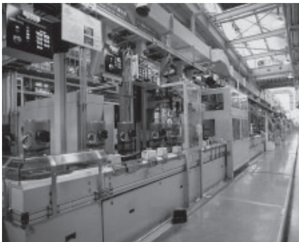
スクロールコンプレッサ組立ライン（臨海工場）
