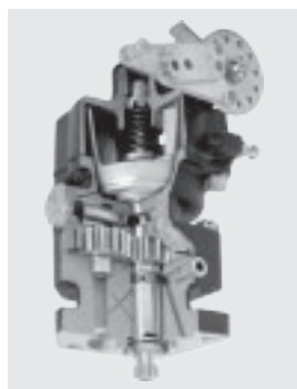
陸軍機用油圧式ガバナの断面
