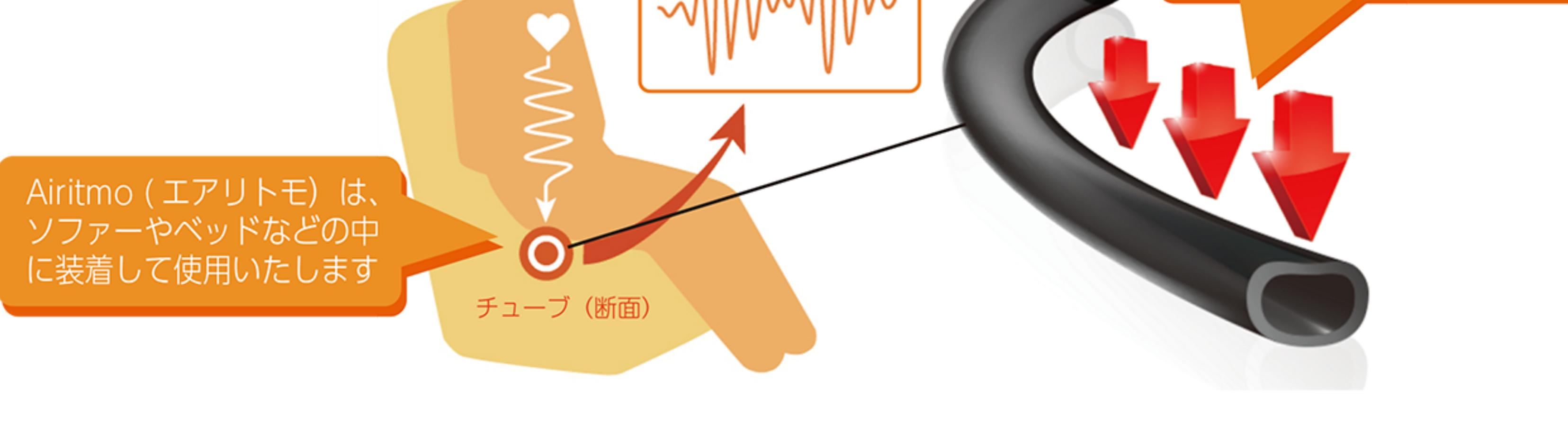
人の体は心臓の物理的な動きに伴って微かに振動しています。Airitmo（エアリトモ）では、この振動をチューブ内空気振動として高感度圧力センサーで捉えて信号処理をすることによって、心拍や呼吸、体動情報を抽出しています。長年のデータ蓄積、大学、企業との共同研究によって、心拍測定精度等について多くのエビデンスを獲得しています。
