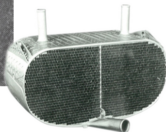
創業時代に製作していた 飛行機用ラジエーターチューブ
