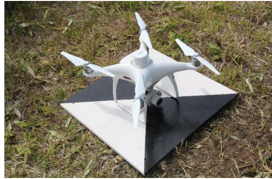
写真 1-8. 空撮に用いた測量用のドローン (2020 年 7 月 20 日).
