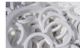
回収された再生用のPTFE原料
