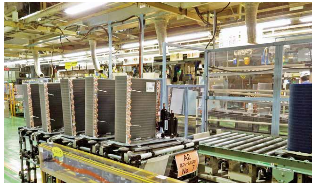
従業員考案の「からくり」。推力を利用することで省エネルギーを実現しながら部品を生産ラインへ供給
