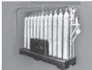
大型炭酸ガス消火装置
