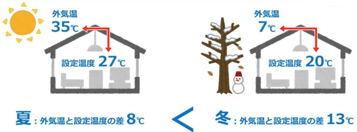
こうしたエアコンの熱を汲み上げる技術は「ヒートポンプ」と呼ばれています。消費電力が大きくなりがちなエアコンですが、空気中の熱を効果的に利用する「ヒートポンプ」はガスや石油等の化石燃料を燃やす暖房と比べ、温室効果ガス排出を少なくすることができます。政府が2030年度までに温室効果ガスの46%減（13年度比）の目標を掲げるなど、地球温暖化抑制のために「脱炭素（カーボンニュートラル）」が急がれている中、エネルギー消費の大きい暖房機器においても、CO2排出の少ない機器を選ぶという観点も、今後さらに重要になってくると考えられます。
