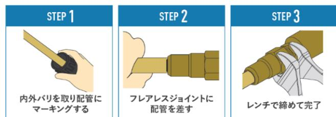
あわせて「フレアレスジョイント」の施工品質の安定化に役立つ「マーキングゲージ」も付属して出荷するため、冷媒配管接続の施工ミスや施工レベルのばらつきを抑えられます。
