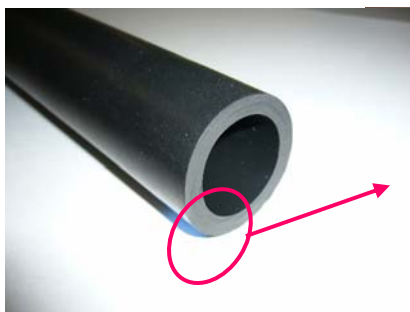
フッ素ゴムを使用した 3層構造の燃料ホース写真
