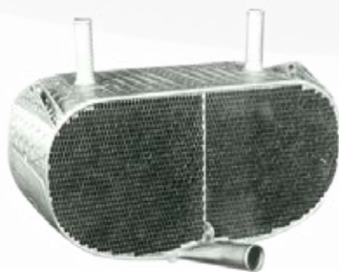
創業時代に製作していた 飛行機用ラジエーターチューブ
