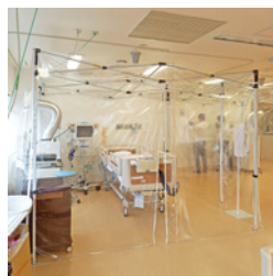
アルミフレームを使った「折畳み式陰圧ブース」
