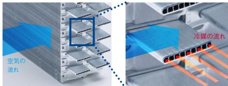
伝熱管を扁平にすることで、伝熱管の周りを通る空気の流れがよくなり、熱交換効率がアップ。
